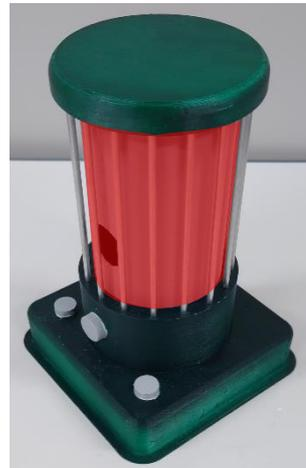
熱のあるストーブは赤い着色だけでなく、内部に熱源を持ちサーモカメラにて判別する事ができます。
