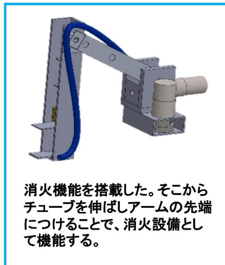
消火機能を搭載した。そこからチューブを伸ばしアームの先端につけることで、消火設備として機能する。
