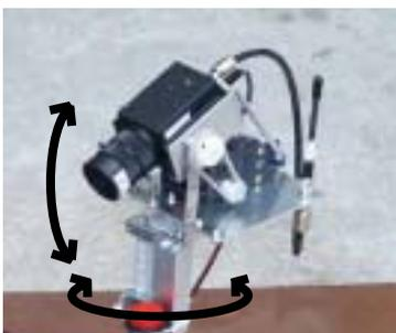
ロボットの操作はカメラからの映像のみを頼りにして行う。しかし、カメラから送られてくる映像の視界には限度があるため、救助作業中に見えにくい場所ができ、死角でトラブルが生じた場合、何の対応も講じることができない。上下左右を自由にすることができるカメラを搭載し、そのような場所や、トラブルを確実にフォローして、その映像を、的確にオペレータ側に伝えることができる。
