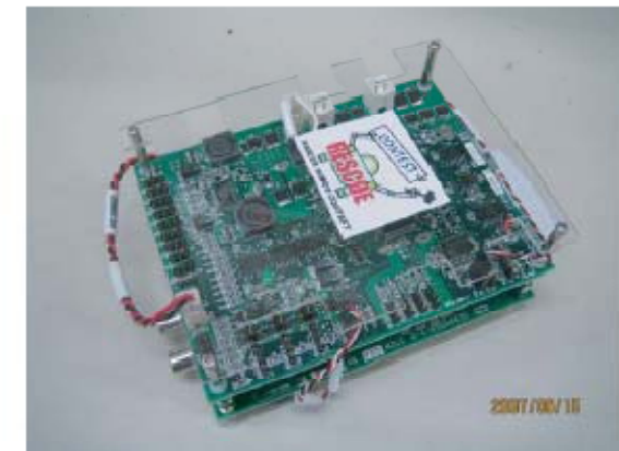
基板面積 100 mm × 130 mm 基板高さ 約60 mm
