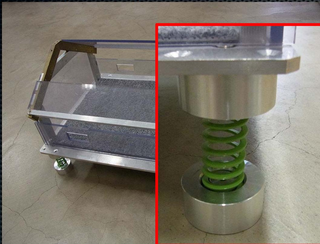
脚に挿入されているバネは完全に固定
