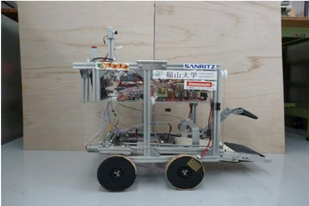
救助機構とガレキ除去などに用いる作業用アームをまとめてロボットに搭載することにより「搜索」「ガレキ除去」「救助」「搬送」という1連の救助の流れを1台ですべて行えるようにしました。1台のレスキューロボットとしては比較的多機能で、1台で1貫して作業を行うことにより、作業を速やかに行えるという利点がありますが、反面、「機体の巨大化」「操縦の複雑化」「機構の複雑化」による低下などの問題も発生します。
