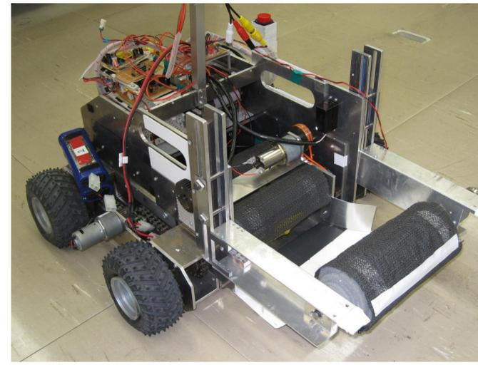
前部に1つと、ベッド内2つ装備した“**スポンジローラ**”でダミヤンをベッド内に誘導して救助します。救助の際、細かな位置合わせが不要な単純な救助機構なので非熟練の操縦者でも救助が可能です。
