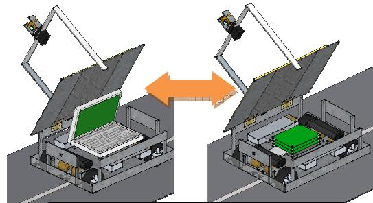
制御系のコアを変えて自律型、遠隔操作型
