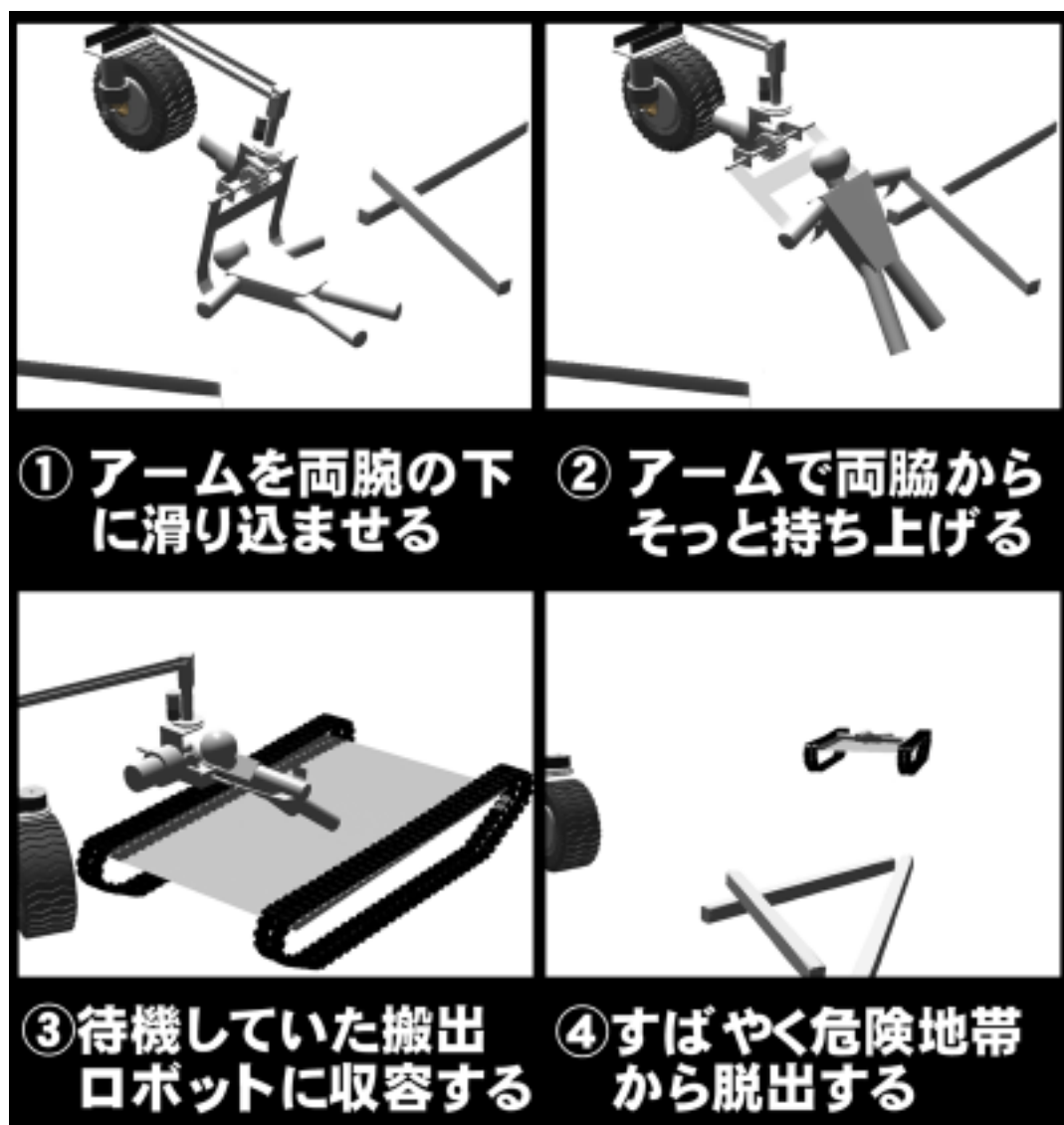
図3 被災者助け上げ、搬送システム
