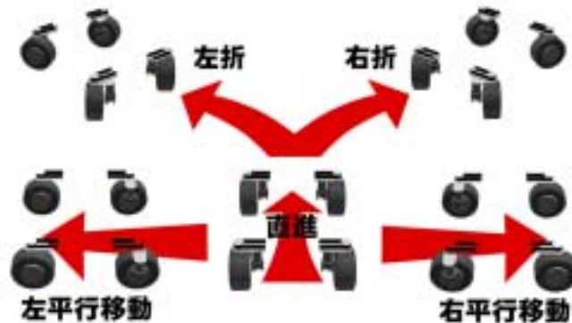
図1 移動方向が自由になる4輪操舵機構
