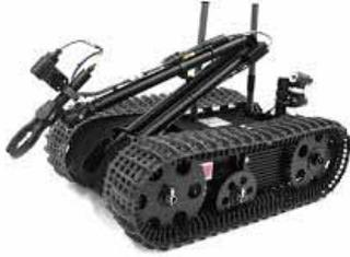
この「タロン」は、米国防務省と共同開発されたロボットで広範囲な用途に対応できるように設計されています。2001年9月11日の同時多発テロでは崩壊したワールドトレードリングセンターでは最後まで救援活動に従事し、現在イラクにおいても多数の「タロン」が活動しております。主な特徴としては、小型軽量で多様なセンサー、機器類の搭載移動能力及び地形を選ばない走行能力、スピードと強固で水陸両用の全天候型ロボットです。
