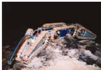
蒼龍 号機はそれぞれがクローラで囲まれた3つの車体からなり、前部車体に被災者探索機器、中央車体には全駆動系とバッテリー、後部車体には無線装置を搭載した、自立走行可能な探索機器である。細長い形態と運動性能によって、蒼龍 号機は3自由度しか有していないにもかかわらず、地形に適応した体型をとる事ができ、へび型移動体特有の高い不整地走行性を発揮し、災害現場の探査作業を大きく補助するものと考えられる。
