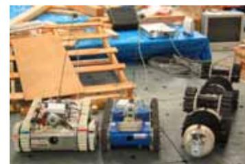
自然災害である地震から人為的なテロまでいろいろな災害発生時に災害現場に取り残された被災者を探索して発見する目的でUMRS (Utility Mobile Robot for Search)を開発しています。今回はこれら開発中の多様な人命発見型ロボットから、クローラ型として腕のついたロボットと重心移動型のロボット各一台、より瓦礫内を自由移動できることを狙ったへび型のロボット1台を展示しています。
