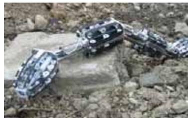
震災などによってできたガレキの内部に入って行き、要救助者を探索するロボットです。特徴は、多関節型であること(ヘビ型)と体の上下左右にクローラが装着されていることで、この事によって狭いガレキの隙間をこじあけて中に進入できます。
