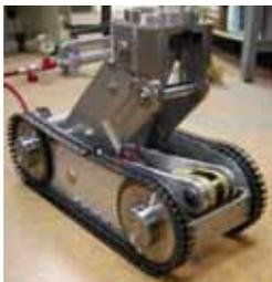
震災などの災害現場でガレキなどを持ち上げることでできるパワーのある油圧シリンダを用いたレスキューロボットを開発しました。このロボットは最大で3.5トンまで持ち上げることができ、自動車は楽々ジャッキアップできることを実験により確認しました。災害現場でガレキの下敷きになった人を助けるためにがれきの中に入り込み、空間を作ることを目指しています。
