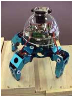
全方向型4足歩行ロボット「Randy」が階段昇降します。また、音声認識で命令できます。
